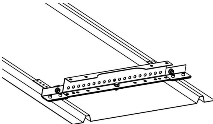
2 Stk Halterungen mit EPDM-Dichtungen werden an den Enden der Stützschiene montiert und mit 14 Bohrschrauben mit Dichtungsscheiben A2 18 x 6 mm auf die Profilgipfel geschraubt.
