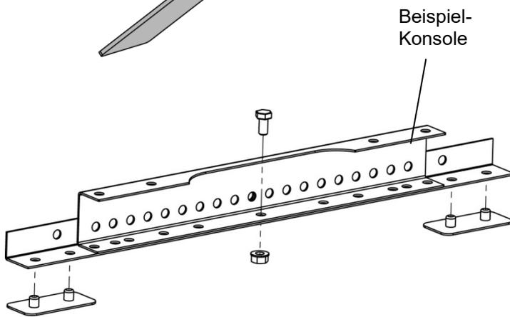
Verlängerungsschiene mit 1 Schraube FZV M10 x 20 und Flanschmutter auf Universalhalterung montieren. EPDM-Dichtungen montieren. Montage gemäß einer der beiden folgenden Varianten.
