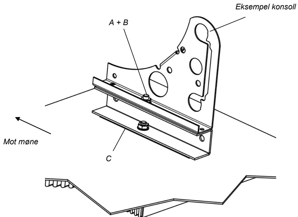
**A= Skrue FZV M10 x 20, B= Flensmutter FZV M10, C= EPDM-pakning**
