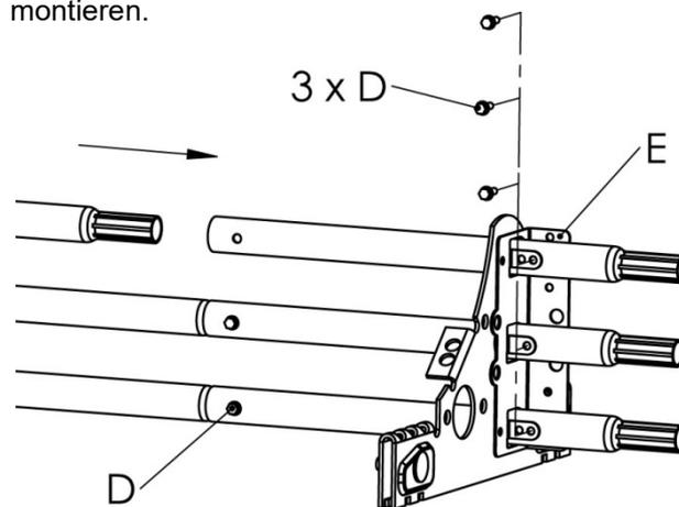
**Schutzanordnung ist für eine Belastung von 500 kg pro Meter dimensioniert.**
