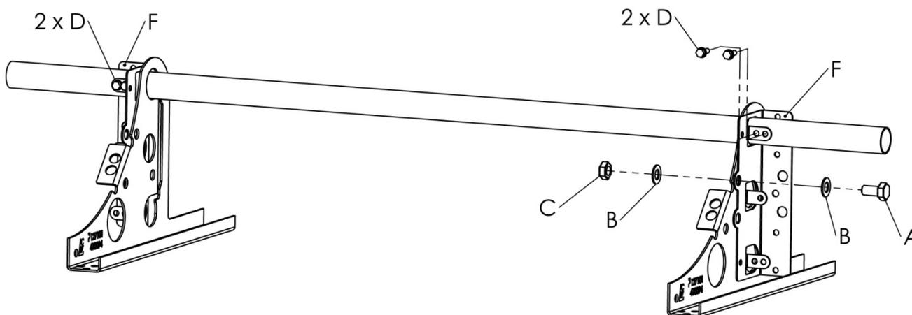
**Firstgitter ist zur Anschlagereinrichtung für persönliche Schutzausrüstung gegen Absturz für eine Person dimensioniert.**
